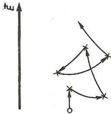
Fig. 4.38. Mișcarea unui gol sub acțiunea unui câmp electric \vec{E} exterior, fiind seama de ciocnirile pe care le are în cristalul real.
